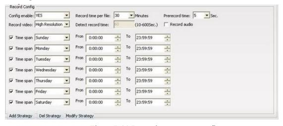
Figure 7-11 Record parameter config
